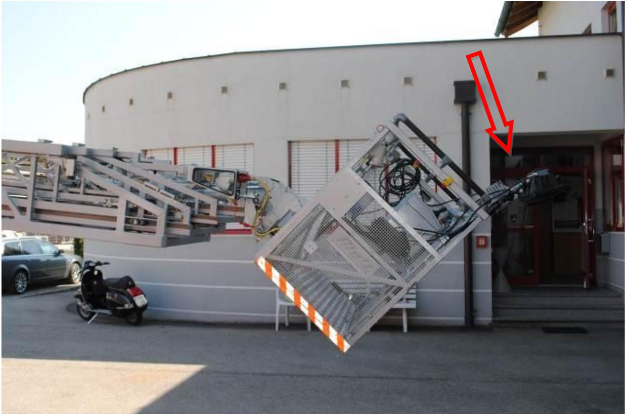
Am Korb können 2 Stück 500 W Scheinwerfer angebracht werden. Somit kann ein großer Lichtkegel erzeugt werden. Ein Stromerzeuger 11kVA sorgt für ausreichend Energie.
